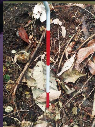
写真：土壌厚測定に用いたピンポール (長さ1m、直径8mm)
